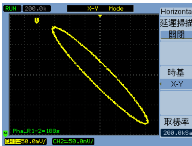
圖 15 顯示超出相位波形的 X-Y 顯示格式
